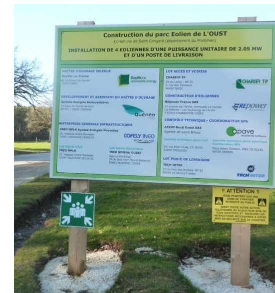
Figure 172. Panneau de chantier avec logo du point de rassemblement en bas à gauche (Crédit photo : Quéneá)
