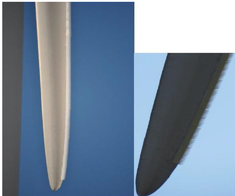
Figure 177: Exemple de serrations mis en place sur les éoliennes (source Vestas)
